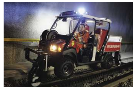
MULE 4010 DT Löschfahrzeug im Bahn-Tunnel
